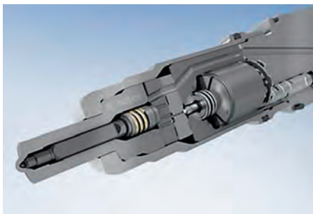
Einspritzdüse und Düsenhalter sind filigran und vierteilig. Hat sich die Pest hier bereits festgesetzt, muss oft der Fachmann ran
