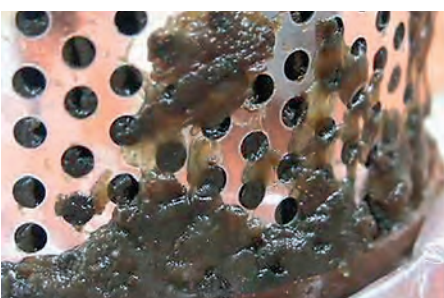
Sieht im ersten Moment aus wie alte Schmiere. Doch am und im Filter, wo dieser „Pudding“ klebt, hätte Fett ja auch überhaupt nichts zu suchen
