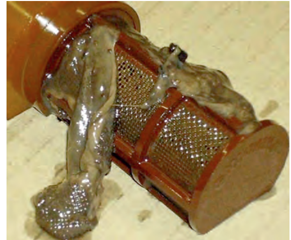
Massiver Befall: Dieser Filtereinsatz ist schon total überwuchert von den gallertartigen Abbauprodukten der Mikroorganismen
