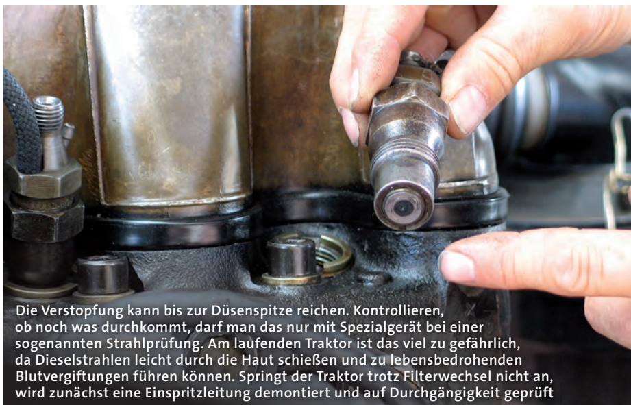
Einspritzdüse und Düsenhalter sind filigran und vierteilig. Hat sich die Pest hier bereits festgesetzt, muss oft der Fachmann ran
