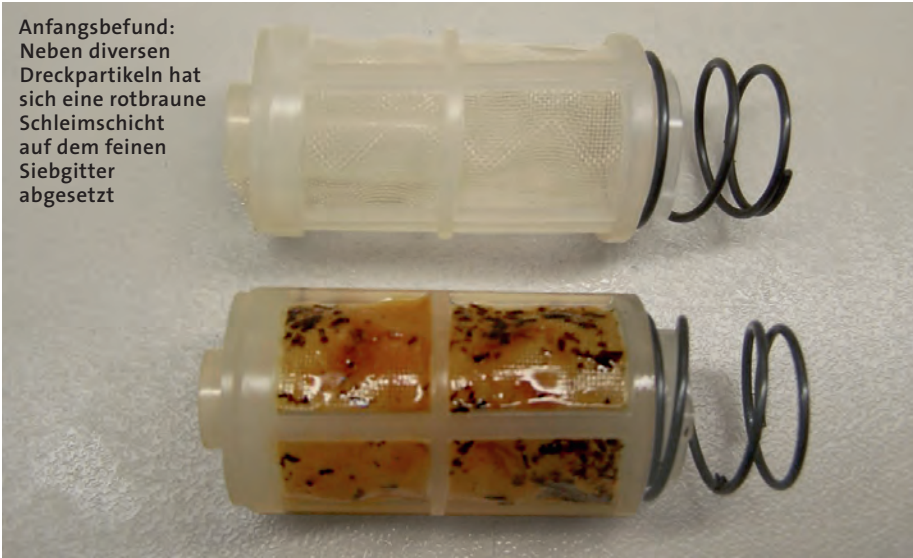
Massiver Befall: Dieser Filtereinsatz ist schon total überwuchert von den gallertartigen Abbauprodukten der Mikroorganismen
